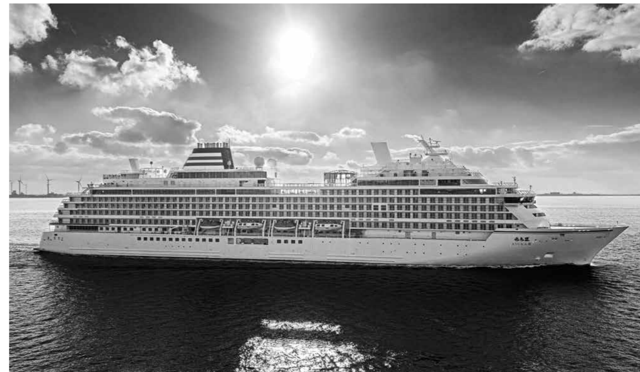
「飛鳥Ⅲ」は全長230m、全幅29.8m、総トン数は5万2265GT、船籍港は横浜（提供：郵船クルーズ）
