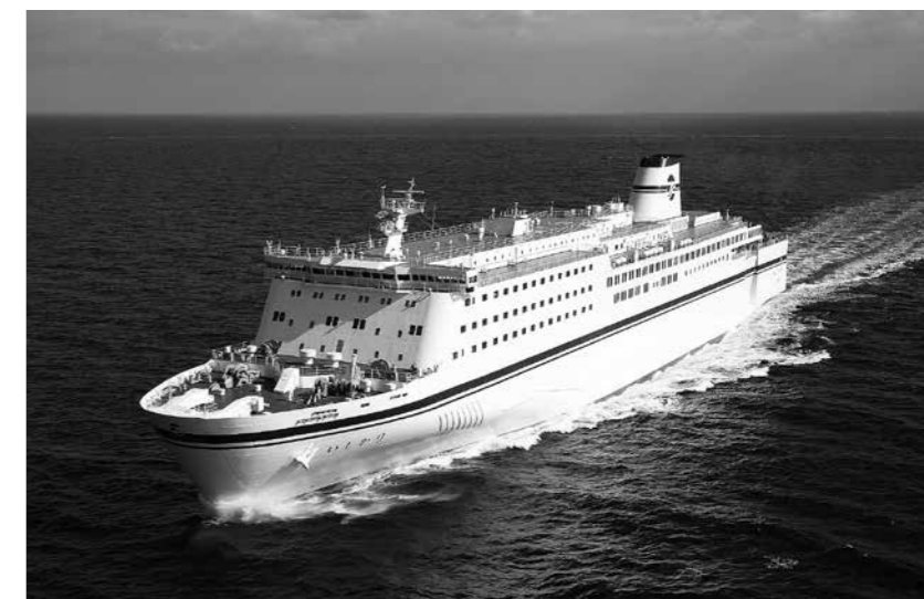
「いしかり」は全長199.9m、全幅27.0m、旅客定員777人、車両輸送能力は乗用車100台、トラック184台(提供：太平洋フェリー)
