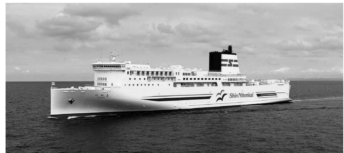
新造船「けやき」は全長199.0m、総トン数1万4157トン、積載台数はトラック150台・乗用車30台(提供：新日本海フェリー)
