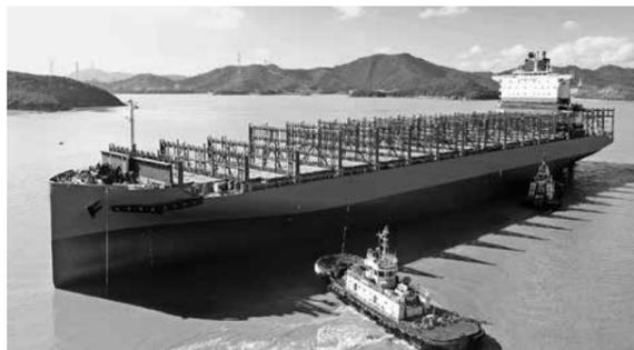
今回進水した船は常石グループが建造するコンテナ船としては最も大きく、20フィート換算でコンテナを5915個まで積載できる。また、冷凍コンテナは1400個まで搭載可能だ。
