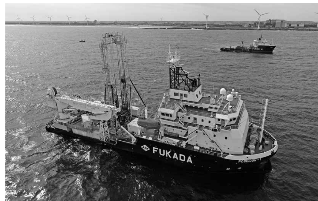
地盤調査にも対応する多目的作業船「POSEIDON-1」
