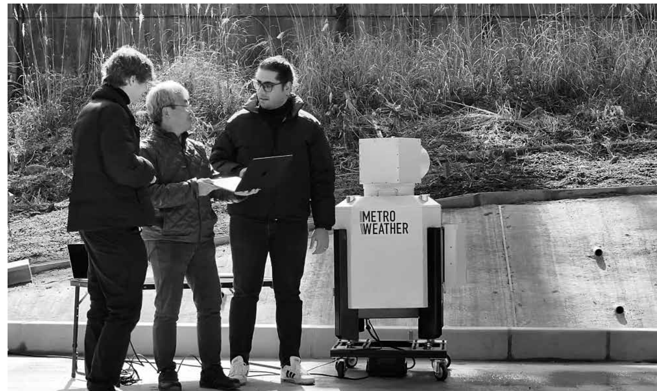
小型ドップラー・ライダー「Wind Guardian」はサイズが65cm四方、重さが180kg、観測距離が最大半径15km
