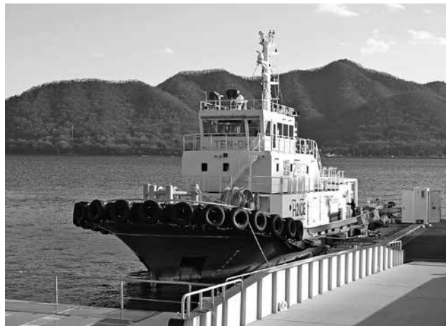
昨年12月、ゼロカーボン航行に成功したタグボート「天欧」(左)。2基の水素混焼中速エンジン(右)を搭載している(提供：日本財団)
