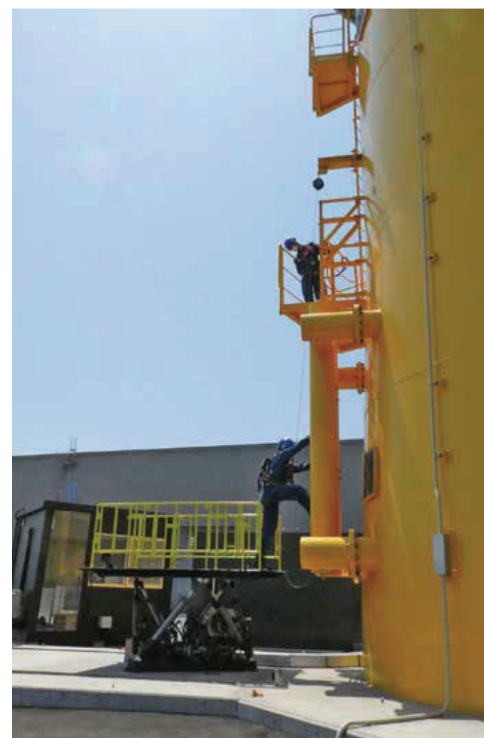
乗り移り訓練のデモ。CTVを模したゴンドラの下にシリンダーがあり、縦・横・斜め・前後に激しく動いて波の揺れを再現する
